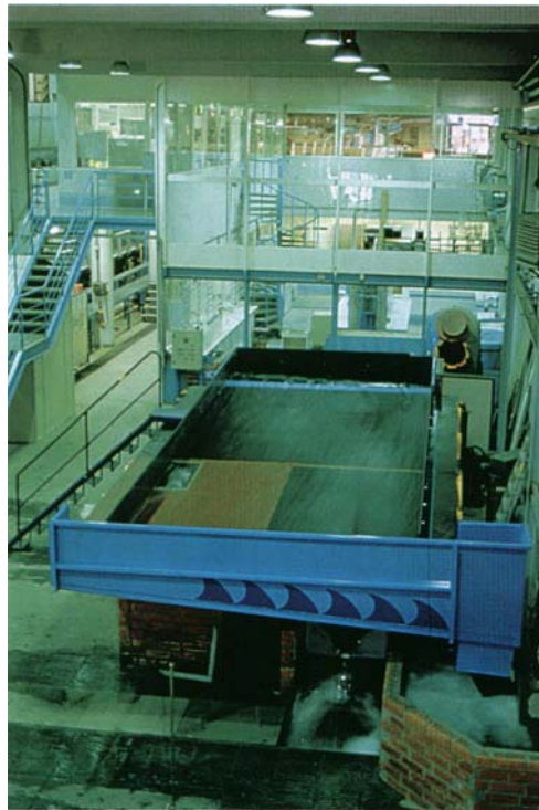
Figura Nº 1.6: Dispositivo para ensayos de flujo en calzada y sumideros (Fuente: Universidad Politécnica de Cataluña, Barcelona, 2000).
